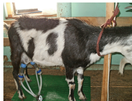
Доильный аппарат ДАД-01К в работе
