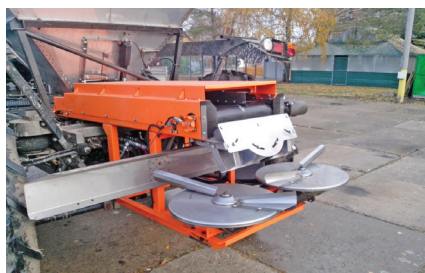
Рабочие органы: ленточный транспортер с делителем и разбрасывающие диски
