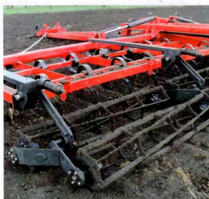
Рабочие органы (лапы на S-образных пружинных стойках и катки)
