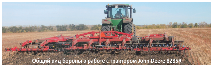
Рабочие органы (сферические диски, пружинные боронки)
