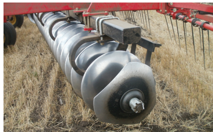
Рабочие органы (сферические диски, пружинные боронки)
