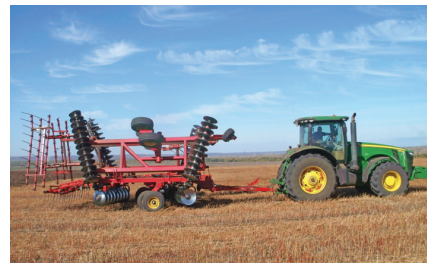
Общий вид бороны в транспортном положении с трактором John Deere 8285R
