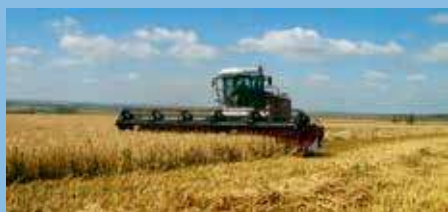
Шасси ШС-150 в агрегате с косилкой КВТ 9-18 в работе
