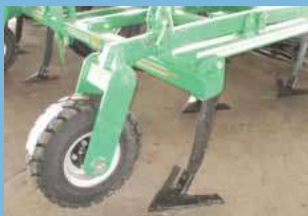
Опорное колесо с механизмом регулировки
