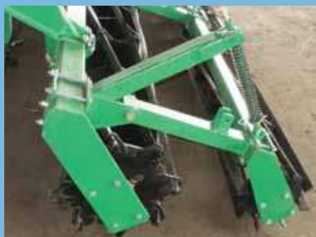
Катки опорные – первый ряд и прикатывающие – второй ряд
