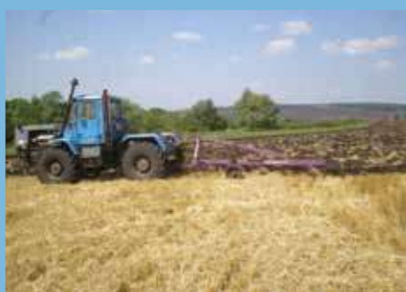
Плуг ПЛНУ-5-35 в работе в агрегате с трактором ХТЗ-150К.
