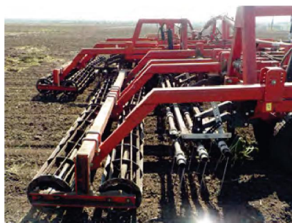
Опорные двойные катки и трехрядные пружинные бороны
