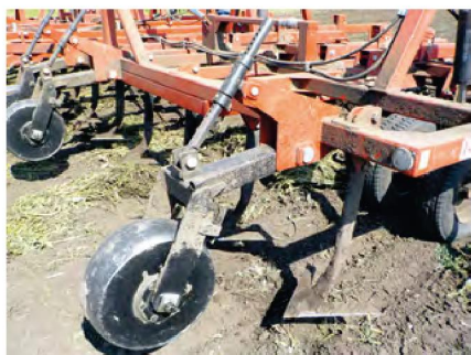
Стрельчатые лапы и опорные металлические колеса
