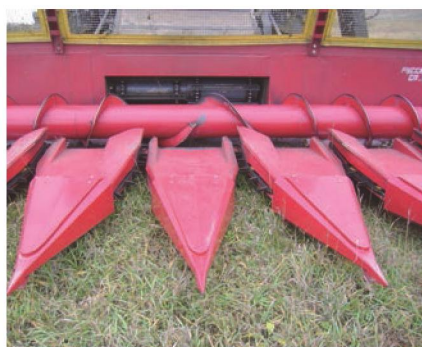
Рабочие органы приспособления для уборки подсолнечника НАШ-1273-04
