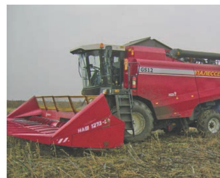
Приспособление для уборки подсолнечника НАШ-1273-04 в работе в агрегате с комбайном КЗС-1218
