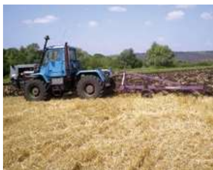
Плуг ПЛНУ-5-35 в работе в агрегате с трактором ХТЗ-150К
