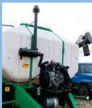
Моторная установка пневматической системы транспортировки семян
