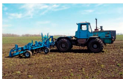
Культиватор КНК-7,2-01 в работе с трактором ОпТЗ -150К
