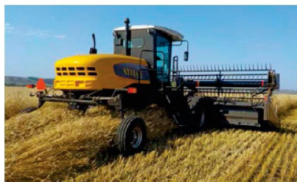
Косилка КС-100 «Чулпан» в агрегате с жаткой ЖВ-760 в работе на скашивании озимой ржи
